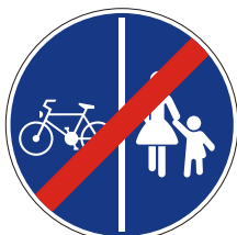
III - 25 Konec steze za pešce in kolesarje
