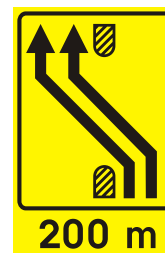
III-114 Predznak za preusmiritev pro- meta na cesti s fizično ločenima smernima voziščima
