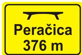
III - 66 Ime viadukta
