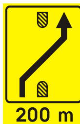
III-114.2 Predznak za preusmiritev pro- meta na cesti s fizično ločenima smernima voziščima
