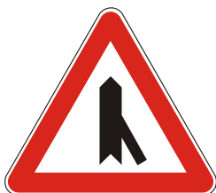
I - 29.1 Stranska cesta, ki pripelje na prednostno z desne strani pod ostrim kotom
