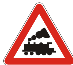
I - 37 Prehod ceste čez železniško progo brez zapornic ali polzapornic
