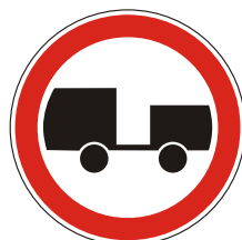
II-10 Prepovedan promet za motorna vozila, ki vlečejo priklopno vozilo, razen polpriklopnika, lahkega prik- lopnika ali bivalnega priklopnika
