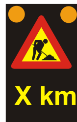
VI-7 Pomična signalna tabla s spreminljivo vsebino
