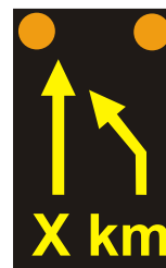
VI-7 Pomična signalna tabla s spreminljivo vsebino
